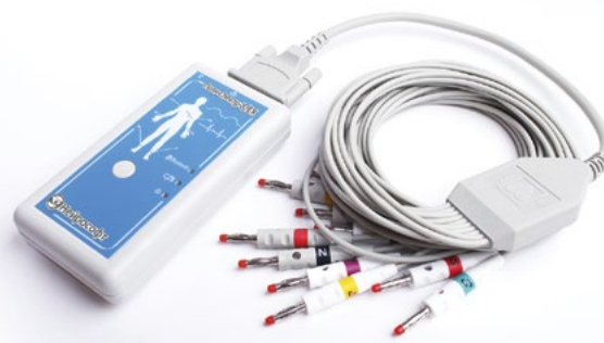
«Поли-Спектр-8/ЕХ» — беспроводной миниатюрный электрокардиограф
